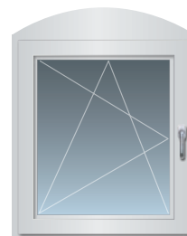
Drehkippfenster rechteckig mit Pass- stück Stichbogen
